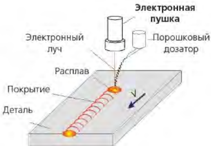
Рисунок 1.2.3.3 - Схема работы метода электронно-лучевой наплавки
