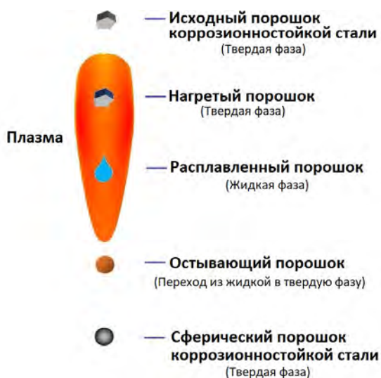
Рисунок 1.3.1.2 - Схематическая иллюстрация сфероидизации порошка в термической плазме [139]
